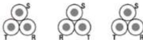
Ilustración 26. Colocación de cables en tresbolillo
