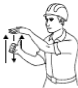
4 LEVANTAR EL AGUILÓN O PLUMA LENTAMENTE
