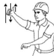
5 LEVANTAR EL AGUILÓN O PLUMA Y BAJAR LA CARGA
