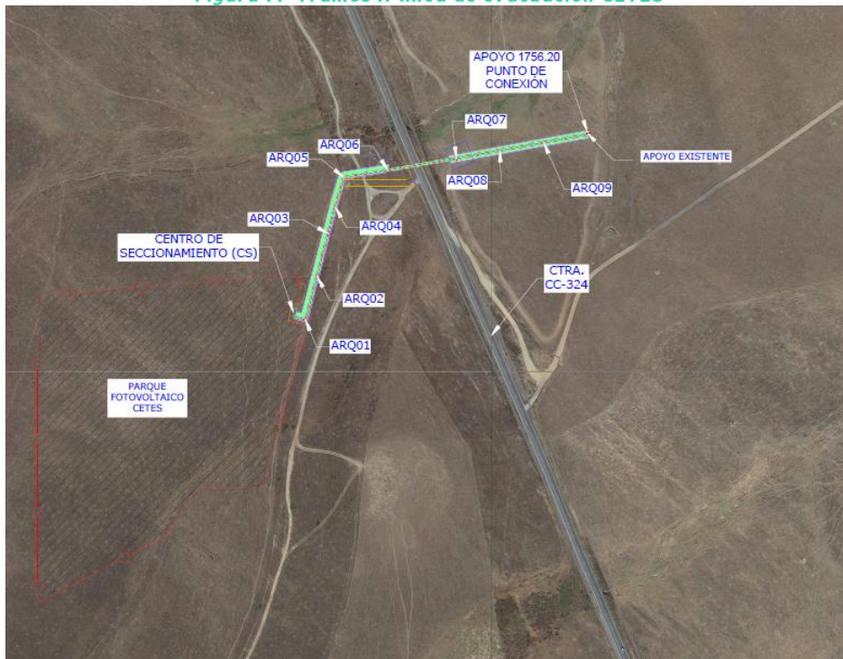
Figura 7.- Tramos II línea de evacuación CETES
