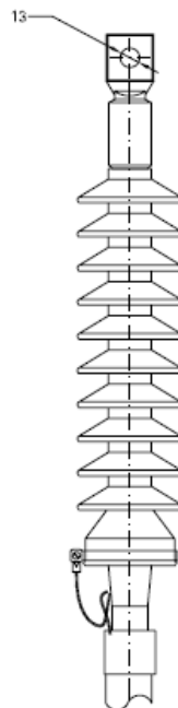
Figura 16. Terminales de exterior.
