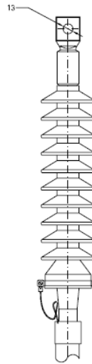
Figura 7. Terminales de exterior.
