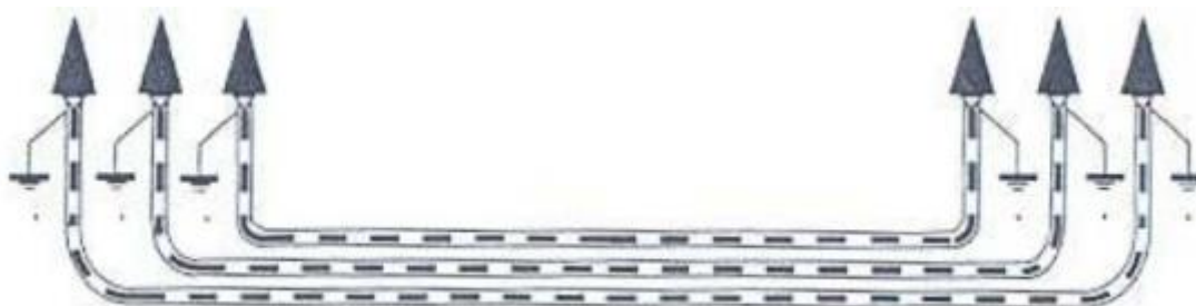
Figura 24: Puesta a tierra de cubiertas metálicas.
