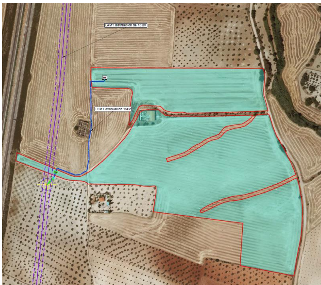
Ilustración 25. Líneas eléctricas aéreas existentes
