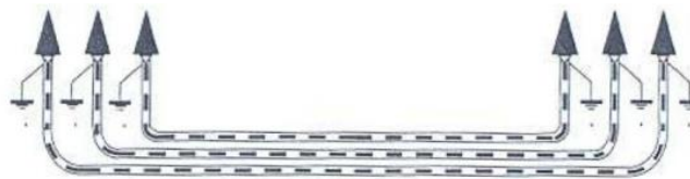
Ilustración 20. Puesta a tierra de cubiertas metálicas
