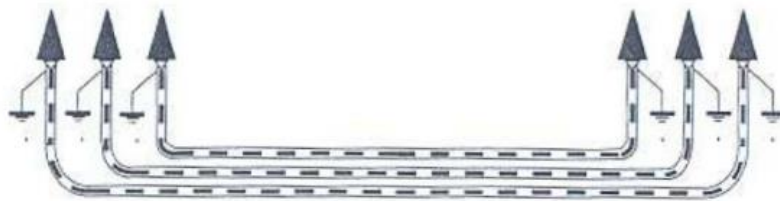
Ilustración 29. Puesta a tierra cubiertas metálicas
