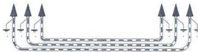
Ilustración 20. Puesta a tierra de cubiertas metálicas
