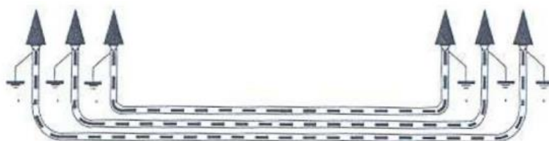
Ilustración 26. Puesta a tierra cubiertas metálicas
