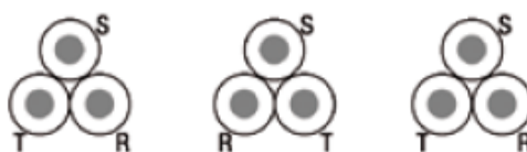
Ilustración 25. Colocación de cables en tresbolillo
