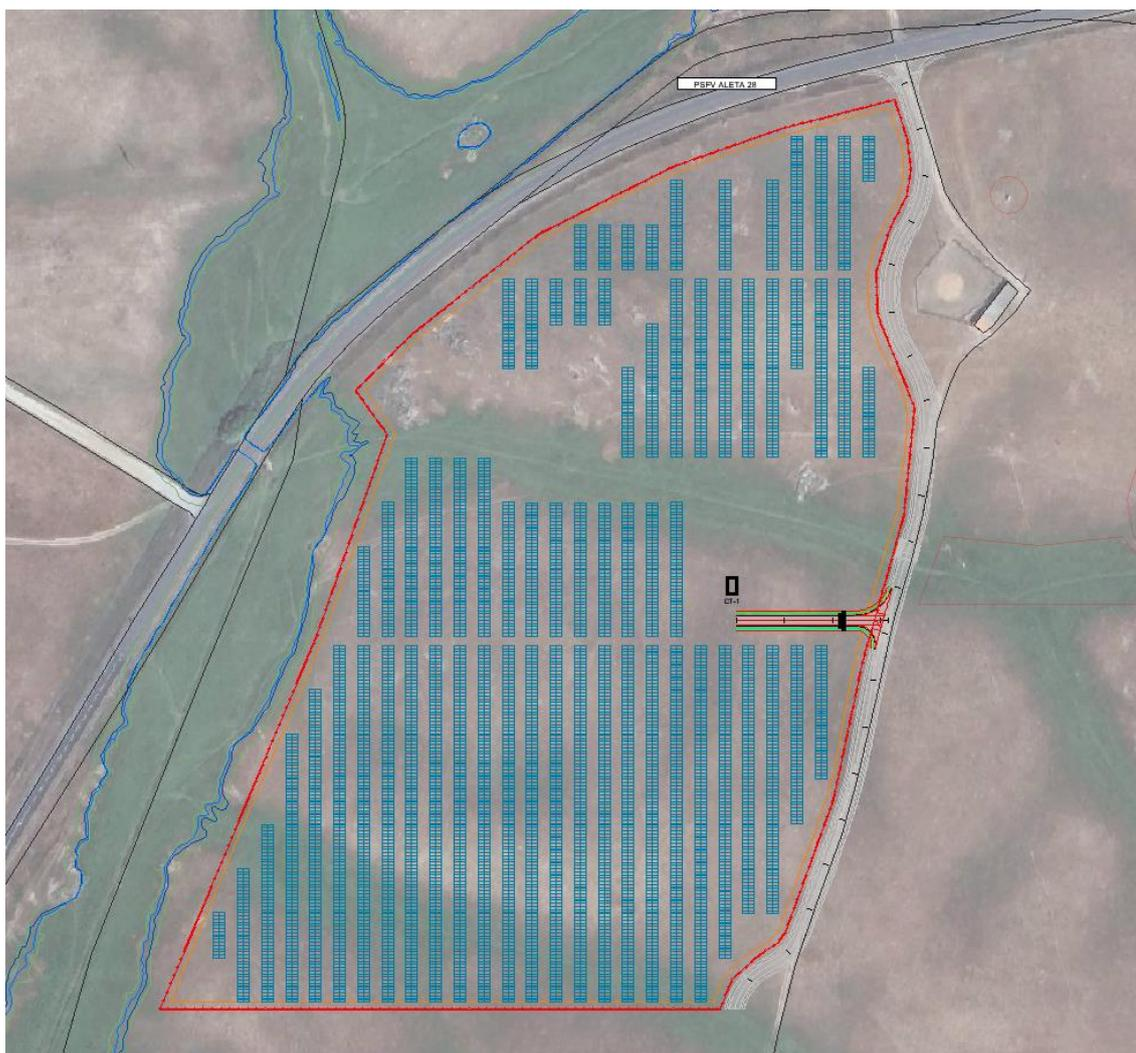
ILUSTRACIÓN 5: IMPLANTACIÓN DE LA PLANTA FOTOVOLTAICA.
