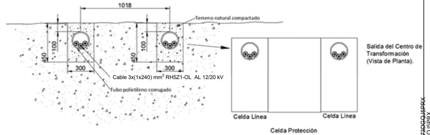
Zanja Tipo 5. Conexión entre Centros de Transformación (Paso a bajo tubo)
