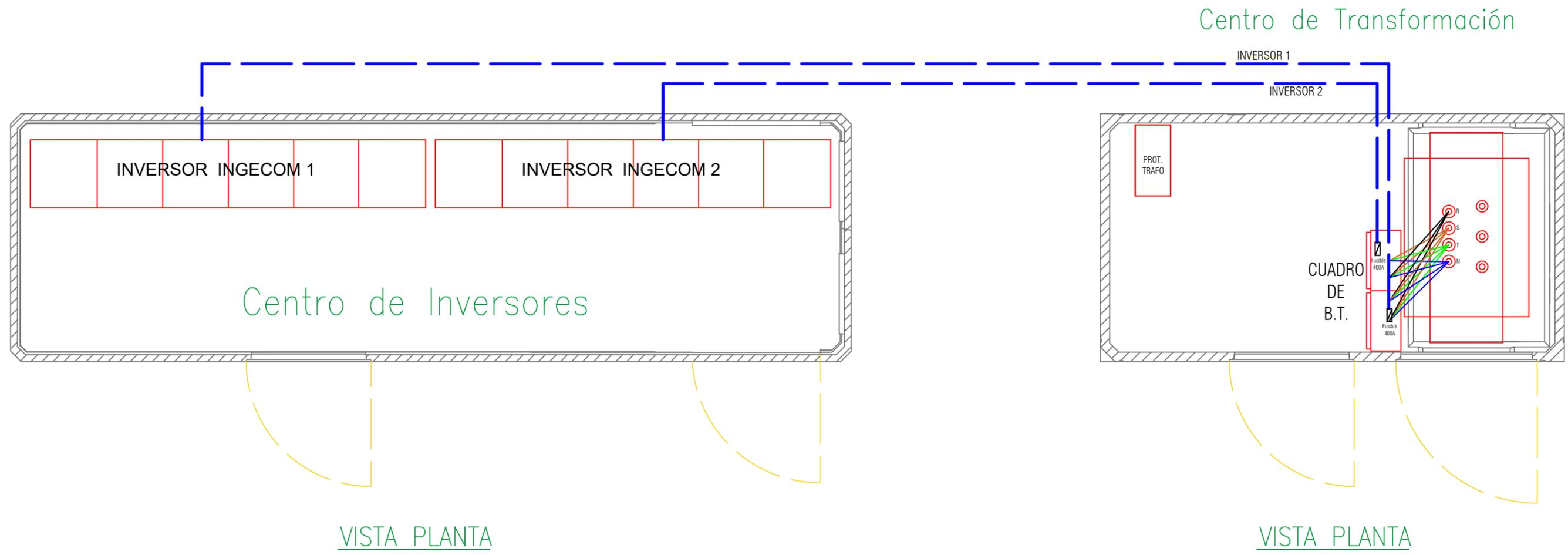
Líneas de Inversor a Transformador: de 3(1x240)+150 mm<sup>2</sup> AL RHV 0,6/1 kV
