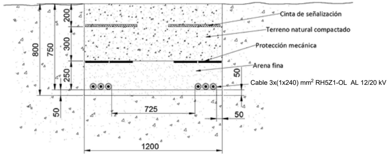
Zanja Tipo 6. Conexión entre Centros de Transformación (Acometiendo a CT)
