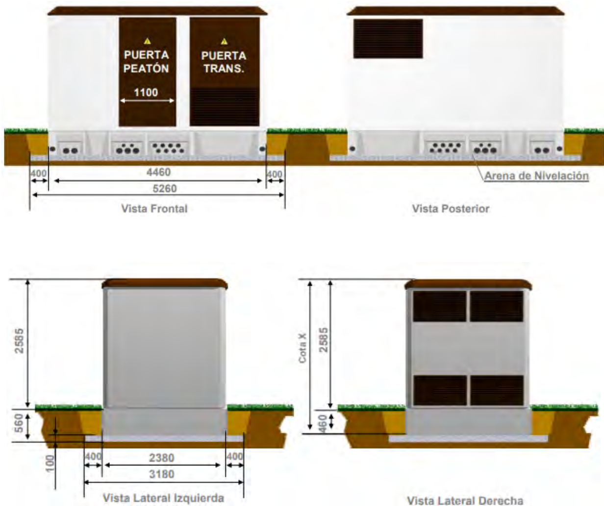
Ilustración 8.1 - Doc. I. Memoria – Edificio prefabricado pfu-4/20 para el Centro de transformación
