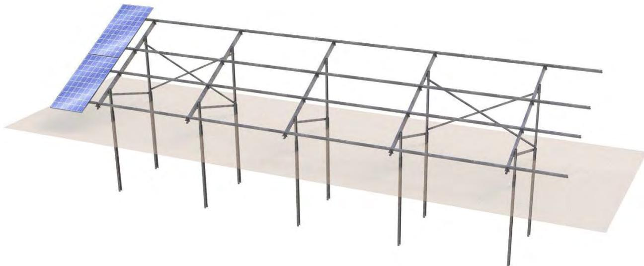
Ilustración 8.3.6 - Doc. I. Memoria – Estructura fija inclinada, doble poste hincado.
