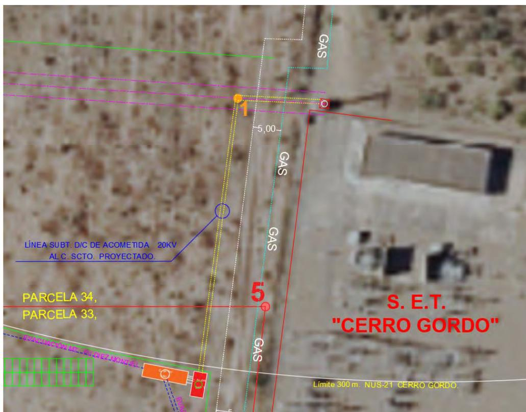
Ilustración 12.1 - Doc. I. Trazado Línea -Subterránea MT, 20kV de acometida a la planta FV
