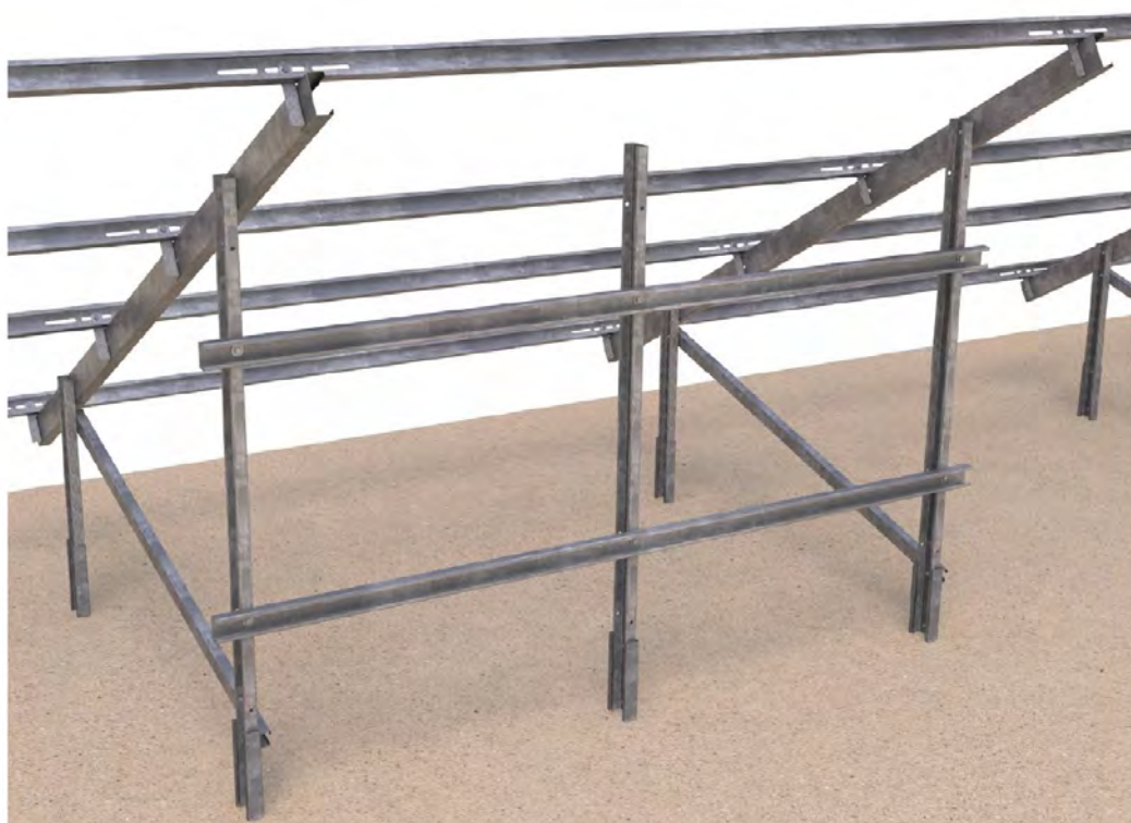
Ilustración 8.3.6 - Doc. I. Memoria – Estructura fija inclinada, doble poste hincado. Vista posterior.
