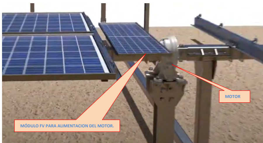
Ilustración 8.6 - Doc. I. Memoria. Módulo FV para la alimentación del Motor del seguidor.
