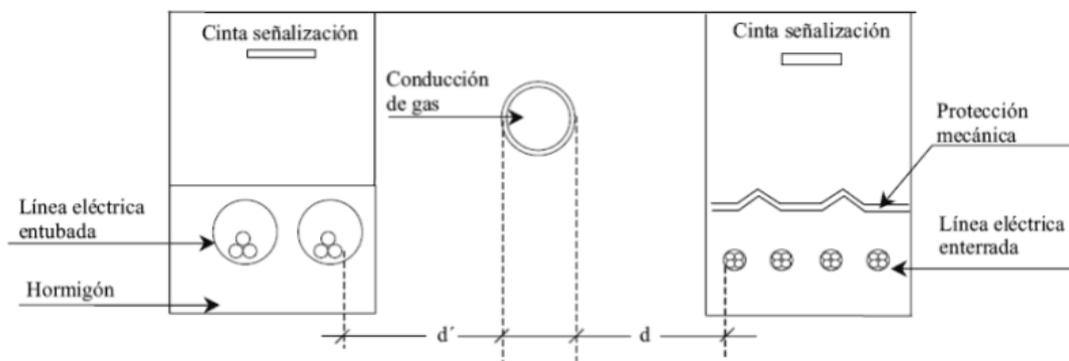
**Figura 31: Detalles de paralelismo y conducciones (ITC-LAT 06).**
