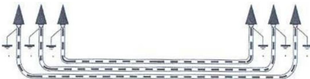
**Figura 27: Puesta a tierra de cubiertas metálicas.**
