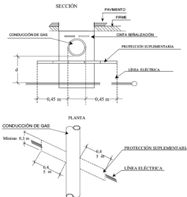
**Figura 29: Detalles de cruzamiento y conducciones (ITC-LAT 06).**
