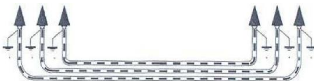
Figura 27: Puesta a tierra de cubiertas metálicas.
