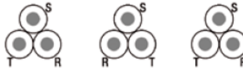
Figura 26: Colocación de cables en tresbolillo.
