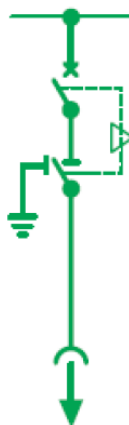
Unidad de protección del transformador
