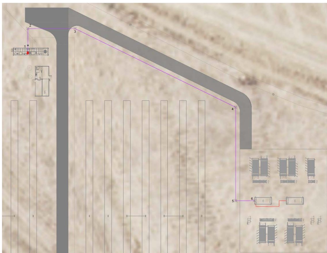
Zanja MT hasta Centro de Seccionamiento
