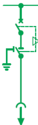
Unidad de protección del transformador
