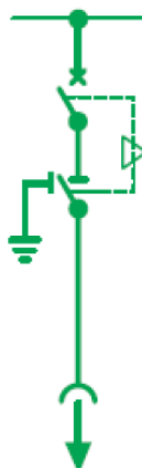
Unidad de protección del transformador
