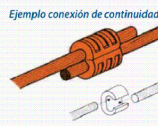
CONEXIÓN DE CONTINUIDAD
