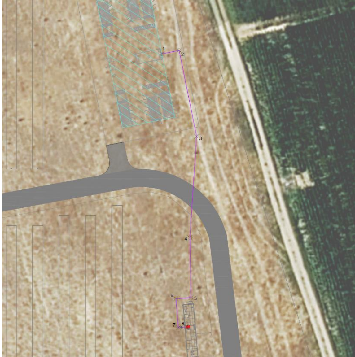
Zanja MT hasta Centro de Seccionamiento
