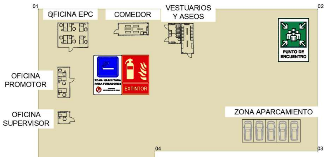
Ilustración 24: Campamento de faenas. Zona oficinas, comedor, vestuarios y aparcamiento
