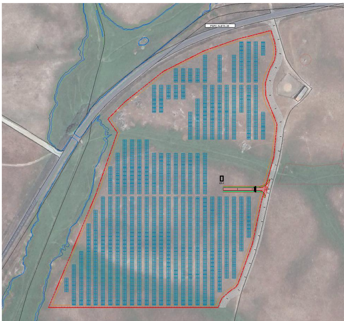
Ilustración 9: Implantación de la Planta Fotovoltaica.
