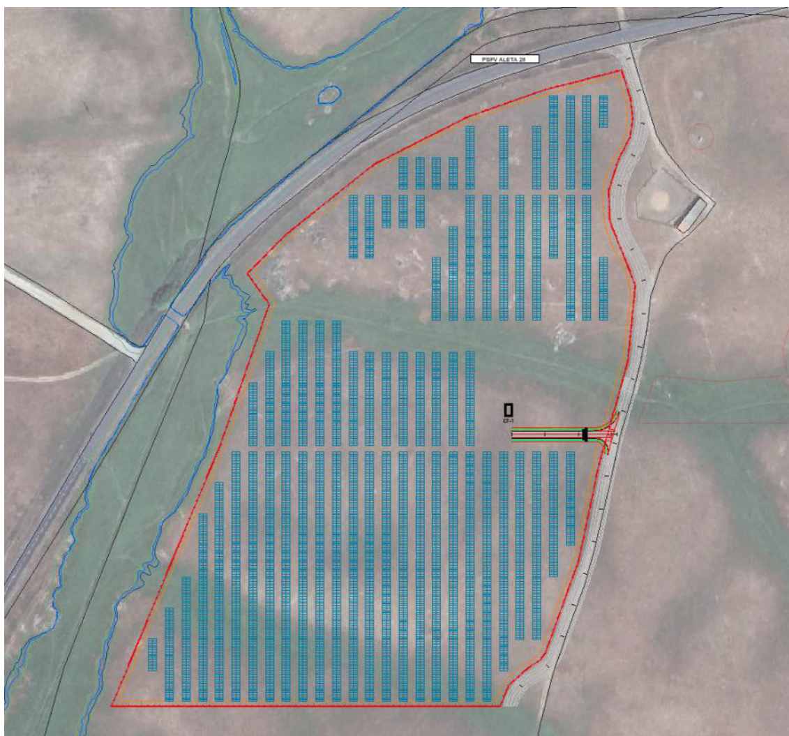
ILUSTRACIÓN 5: IMPLANTACIÓN DE LA PLANTA FOTOVOLTAICA.
