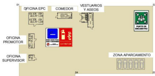
ILUSTRACIÓN 18: CAMPAMENTO DE OBRA. ZONA OFICINAS, COMEDOR, VESTUARIOS Y APARCAMIENTO
