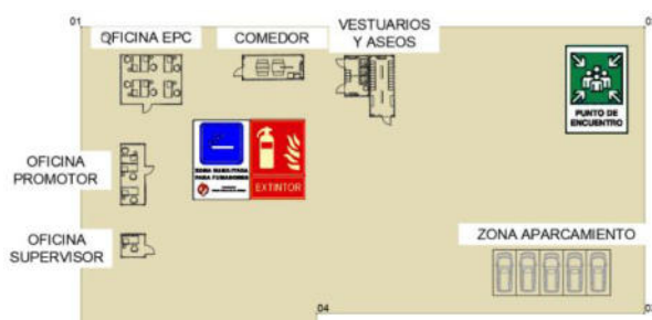
ILUSTRACIÓN 17: CAMPAMENTO DE OBRA. ZONA OFICINAS, COMEDOR, VESTUARIOS Y APARCAMIENTO
