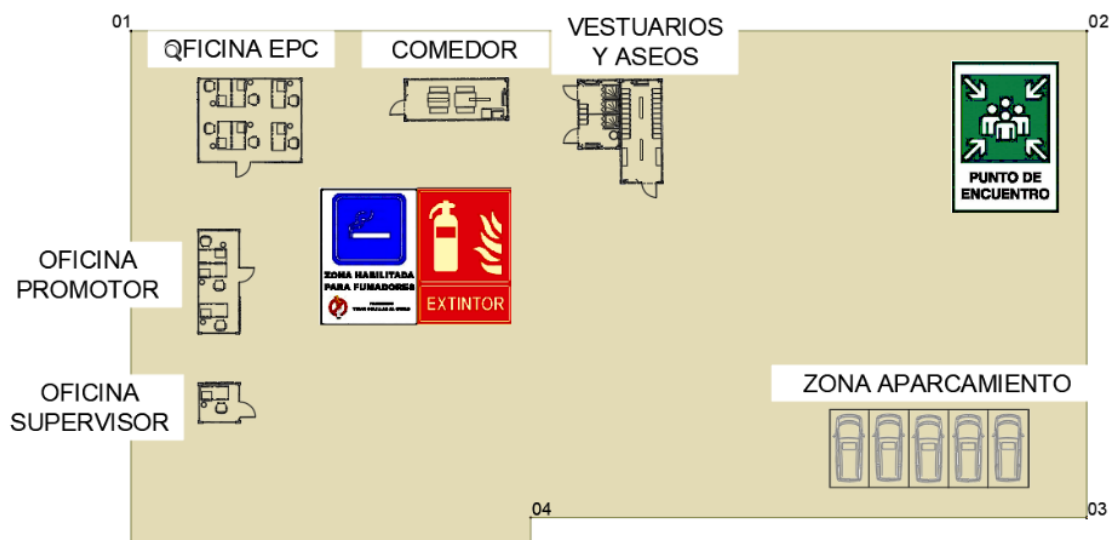
ILUSTRACIÓN 25: CAMPAMENTO DE FAENAS. ZONA OFICINAS, COMEDOR, VESTUARIOS Y APARCAMIENTO
