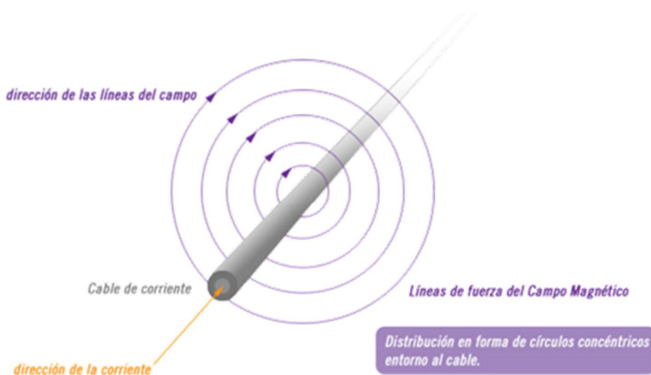
Ilustración 10.- Líneas de fuerza del campo magnético en cable de corriente
