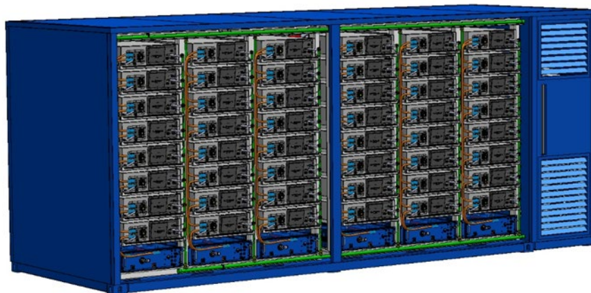
Ilustración 44.- Contenedor de baterías
