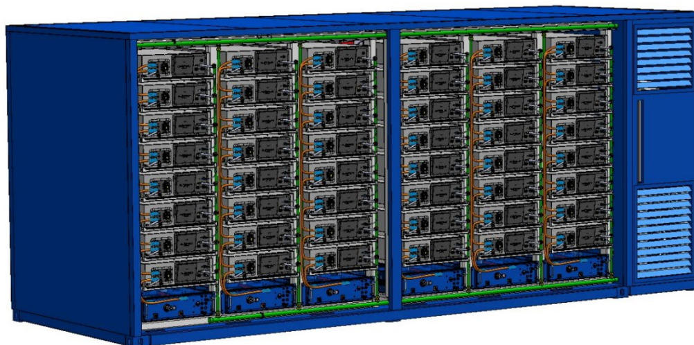
Ilustración 8.- Contenedor de baterías
