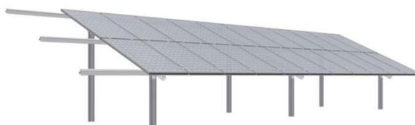
La estructura estará debidamente sostenida y anclada para resistir las preceptivas cargas de viento y nieve, según se indica en el documento básico de seguridad “Bases de Cálculo y Acciones en la Edificación del Código Técnico de la Edificación (CTE-SE), aprobado por el Real Decreto 314/2006 del 17 de marzo de 2006”.
