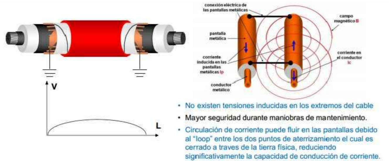
*Las pantallas de los cables aislados se conectarán en ambos extremos solidariamente a tierra, por un lado en los apoyos donde se realizará los correspondientes entronques aéreo-subterráneos y por otro en las estructuras de las correspondientes celdas de línea del nuevo CR proyectado*
