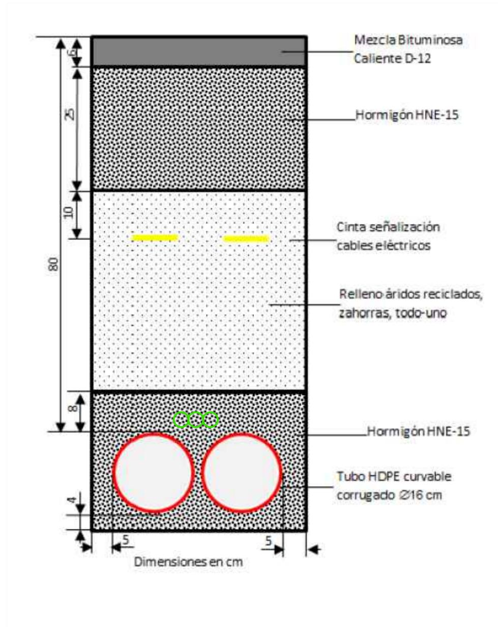
**CANALIZACIÓN ENTUBADA CON 2 TUBOS DE Ø 160 mm en Acerado / Tierra colocados en HORIZONTAL**
