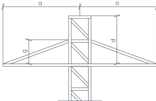
Montaje Triángulo Atirantado
