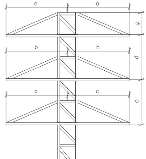
Montaje Doble Circuito Atirantado
