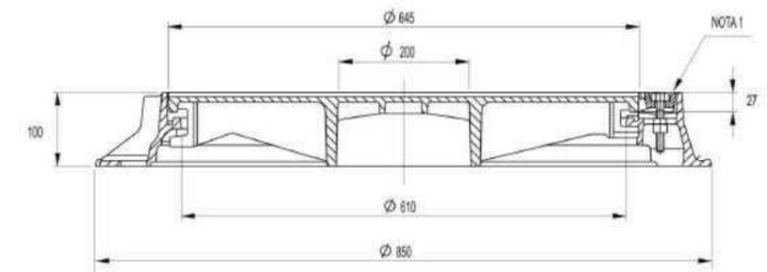
NOTA 1 - DISPOSITIVO DE ASEGURAMIENTO TAPAMARCO SERA MEDIANTE TORNILLO ACERO INOXIDABLE DE M. 14x47 DE CARA HEXAGONAL.
