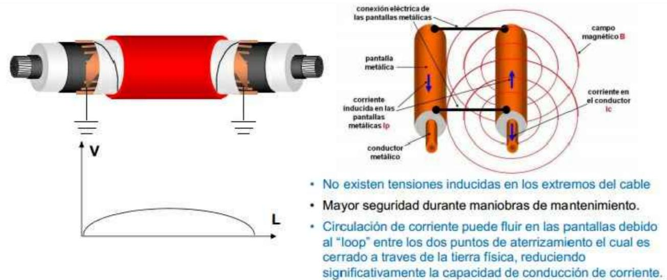
*Las pantallas de los cables aislados se conectarán en ambos extremos solidariamente a tierra, en las estructuras de las correspondientes celdas de línea de los CCTT de origen y fin de la LSMT proyectada*
