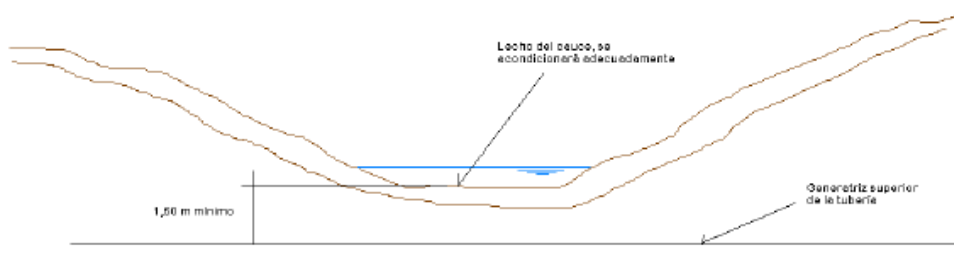
Sección Transversal del cruce con tubería
