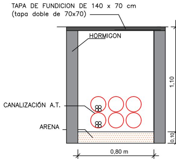
LOS TUBOS DE LAS CANALIZACIONES SERÁN DEL TIPO DECAPLAST DE 6Ø160 MM PARA ALTA TENSION. EN BARRAS DE 6 M. Y NO SE CORTARÁN EN LAS ARQUETAS DE ALINEACIÓN. LA PROFUNDIDAD DE LA ZANJA SERÁ DE 110 CM E IRÁ RELLENA DE TIERRA COMPACTADA EN SU TOTALIDAD.
