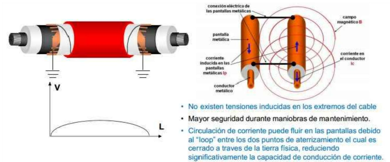
*Las pantallas de los cables aislados se conectarán en ambos extremos solidariamente a tierra, en las correspondientes celdas de línea del nuevo CT proyectado donde hace entrada y salida la nueva LSMT en D/C proyectada*
