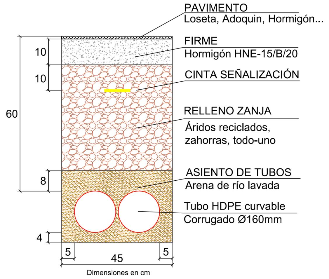
**NI 52.95.03 TUBOS DE PLÁSTICO CORRUGADOS PARA CANALIZACIONES DE REDES SUBTERRÁNEAS. (EXENTOS DE HALÓGENOS)**
