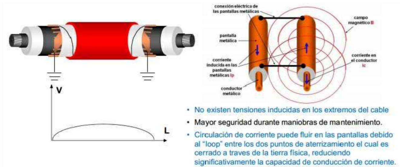
*Las pantallas de los cables aislados se conectarán en ambos extremos solidariamente a tierra, por un lado en los apoyos existentes 2174 y 2175 donde se realizarán sendos entronques aéreo-subterráneos, y por otro en las correspondientes celdas de línea del nuevo CT proyectado donde entran las nuevas LSMT L1 y L2 proyectadas*
