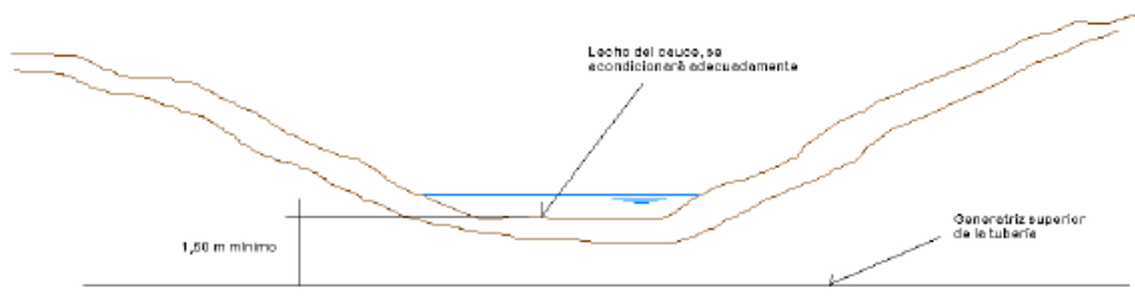
Sección Transversal del cruce con tubería
