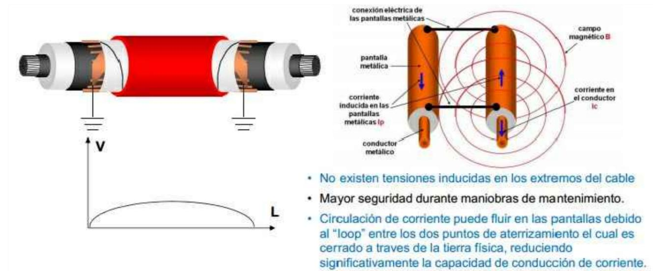
*Las pantallas de los cables aislados se conectarán en ambos extremos solidariamente a tierra, en las estructuras de las correspondientes celdas de línea de los CCTT de origen y fin de las nuevas LSMT proyectadas*
