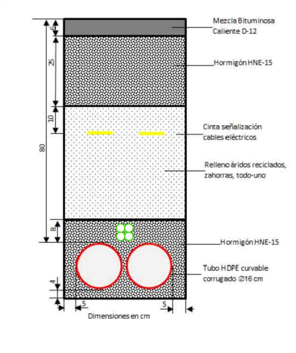
**CANALIZACIÓN ENTUBADA CON 2 TUBOS DE Ø 160 mm en Acerado / Tierra colocados en HORIZONTAL**
