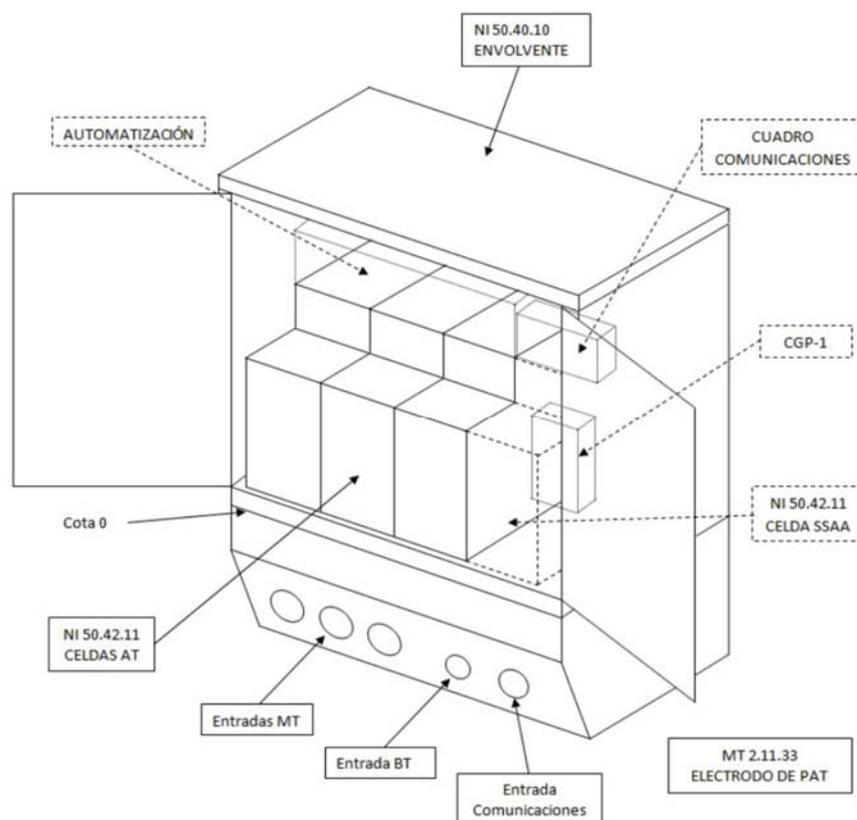
La envolvente prefabricada de maniobra exterior será del tipo EPSSI-24 y cumplirá con las características generales especificadas en el documento de Iberdrola: *NI 50.40.10 “Especificación Particular - Envolventes prefabricadas de hormigón, para Centros de Seccionamiento independientes de superficie, de maniobra exterior, para conexión de instalaciones particulares, hasta 24 kV”*.
