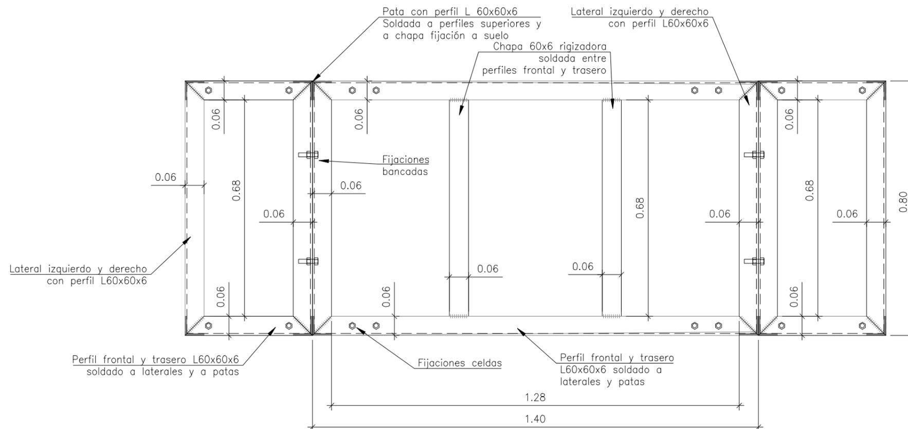
Bancada tipo para ubicación de celdas, las dimensiones definitivas al igual que la ubicación de los tornillos de sujección, dependerán del fabricante de celdas que definitivamente se instalen y del espacio que se obtenga al retirar las celdas a desmantelar
