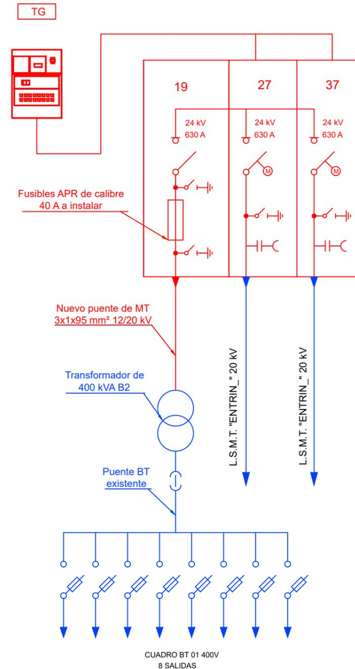
Nuevas celdas modulares 2L+P tipo Ormazabal motorizadas, aisladas en SF6 y telemandadas a instalar
