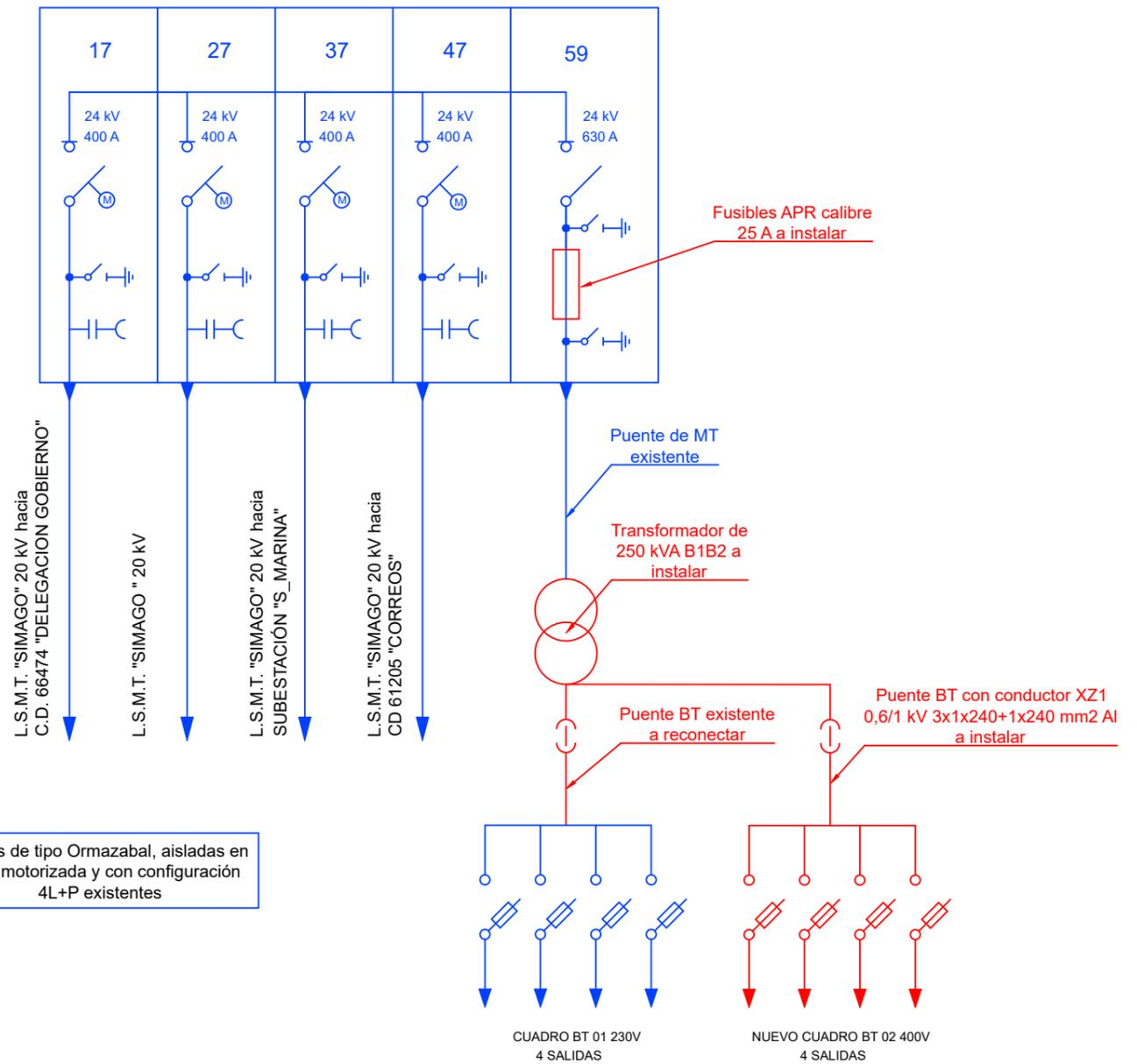
Celdas de tipo Ormazabal, aisladas en SF6, motorizada y con configuración 4L+P existentes
